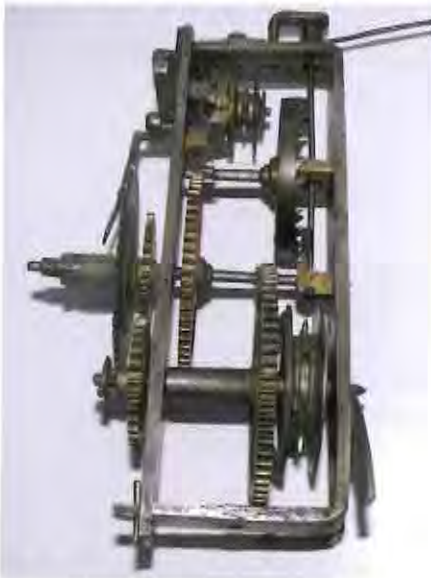
Foto 4 – Het uurwerk is simpel maar robuust gebouwd
