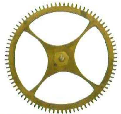
Afbeelding 9 Tandwiel zeskantig geklonken
