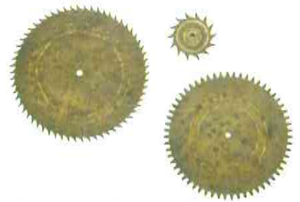
Afbeelding 8 – De passerlijnen zijn op deze tandwielen zichtbaar
