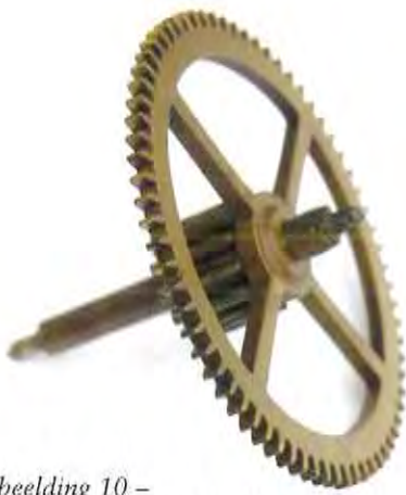
Afbeelding 10 – Tandwiel met bus of 'collet'
