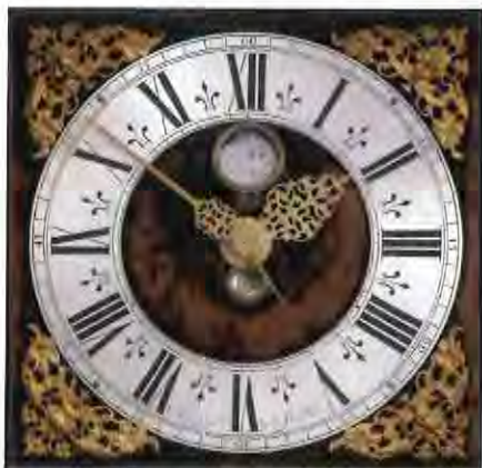
Afbeelding 2 – Wijzerplaat: verzilverde cijferring op met fluweel overtrokken ijzeren plaat
