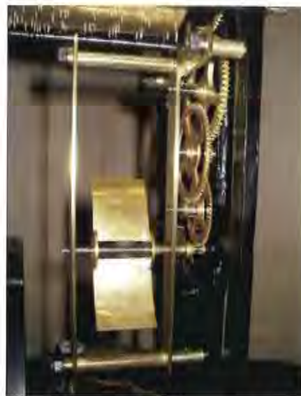
Afbeelding 7 – Het loopwerk van de speelrol (gerestaureerd)
