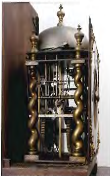
Afbeelding 3 – Uurwerk met getorste pilaren en dubbele zolder
