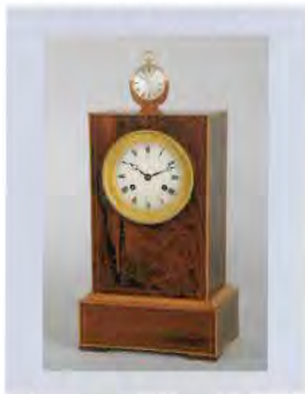
De bekende 'pendule sympathique' van Breguet die op enige vaste tijdstippen een horloge gelijk kan zetten.
