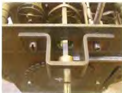
afb. 9 Andere zijde van de platine met de belsteun en ook nog zichtbaar het grote gebogen anker
