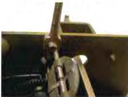
afb. 8 De windvleugel is aan de achterkant gelagerd in een daartoe speciaal in de belsteun geboord gat
