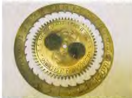
afb. 7 Datum- en maanschijf met de voor Huygens kenmerkende vertanding
