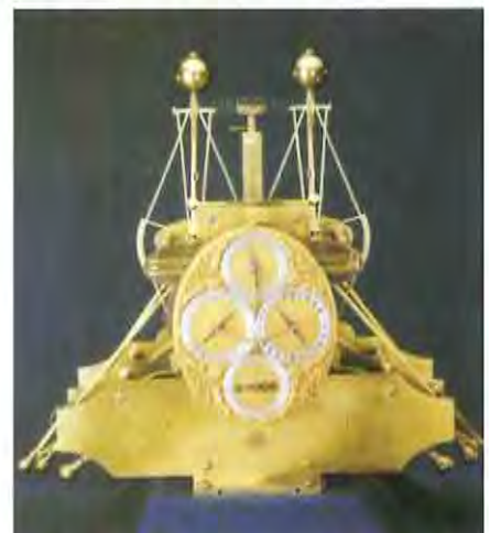
Figuur 6 – Harrison 1. Eerste zeevaardig uurwerk waarmee men lengtegraden kon bepalen. Temperatuurcompensatie. Gewicht 34 kilo (75 pounds) Breedte 1,2 m. Grasshopper escapement. Loopt een dag. Op de eerste proefvaart naar Lissabon, kon Harrison de kapitein van HMS Centurion wijzen op een fout van 60 mijl in de conventionele navigatie. Hij had gelijk, en kreeg dat ook van de kapitein. (Royal Observatory Greenwich)
