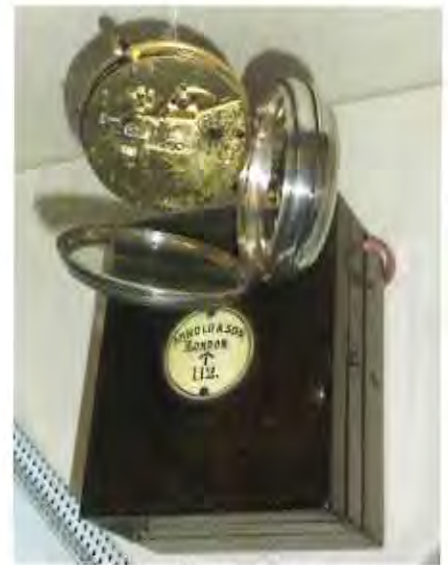
Figuur 13 – Deck Watch van John Arnold en Son. 1790. Werd meegenomen aan dek van een schip, om de exacte tijd van het ‘zonnetje schieten’ vast te leggen. Een aardrotatie van 360 graden duurt bijna 24 uur. Een uur tijdsverschil met London betekent dus dat men 15 lengtegraden van die stad verwijderd was. De essentie van dit soort navigatie is dus het meenemen van een uurwerk wat de Londonse tijd nauwkeurig vasthoudt. (Guild Hall)
