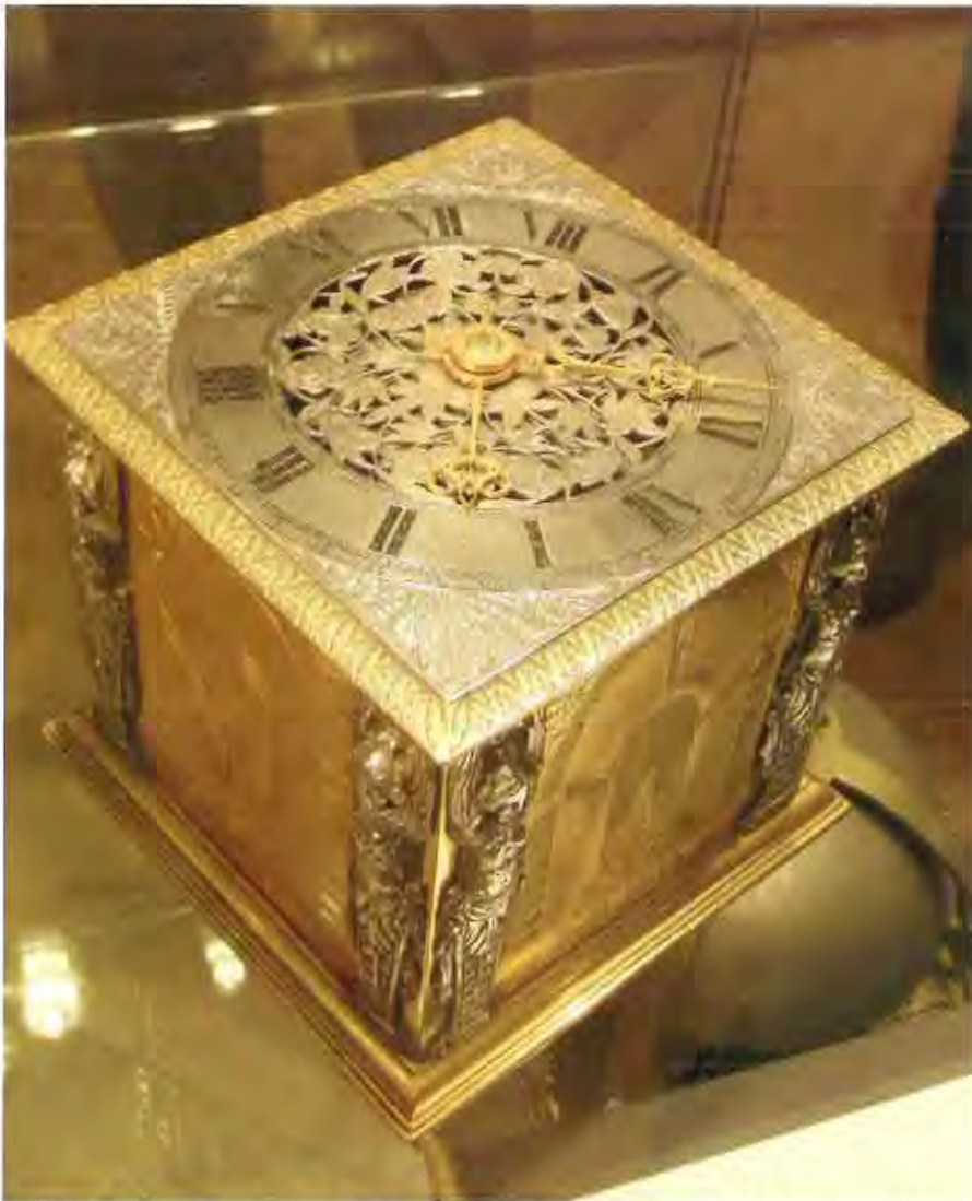
Figuur 12 – Kubusvormige tafelklok van Fromanteel, 1650. Grand sonnerie. Elk kwartier wordt het laatste uur geslagen op de ene bel, plus het aantal kwartieren dat verlopen is op de andere bel. Werk geeft daarom 624 belslagen per 24 uur. Daarnaast bevat het een repeteerwerk: met een druk op de knop kan men de laatst geslagen aanduiding laten herhalen. Spillegang met balanswiel (Bonhams)
