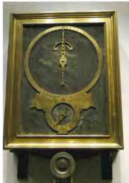
Figuur 3 – Jan van Call, Nijmegen 1657. Gebouwd naar ontwerp van Christiaan Huygens. Dankzij de nieuwe slingertechniek is het nu pas zinvol om een minuutaanwijzing op de bovenste schaal aan te geven. Klok loopt 30 uur op een maal gewicht ophalen. (British Museum)
