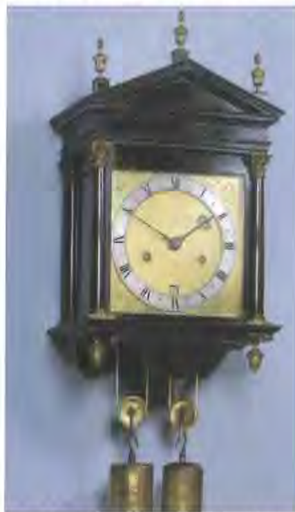
Figuur 8 – 8-daags uurwerk van Edward East. Ongeveer 1660. Een van de eerste Engelse slingeruurwerken die bekend zijn. De klok heeft zeer zware gewichten voor een wandklok. Er zijn er daardoor meerdere die door hun gewicht uit het slechte stucwerk zijn getrokken en op de grond zijn gevallen. Hierdoor zijn maar weinig van dit soort klokken overgebleven. Dit zou pas tien jaar later aanleiding hebben gegeven om dergelijke uurwerken in een staande kast te gaan bouwen. (Belmont House)
