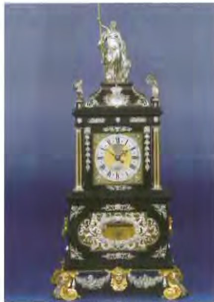
Figuur 2 – Mostyn clock van Tompion. 1695. 74 cm hoog. Eerste klok die een jaar loopt op een maal opwinden. Drie snekopwindingen met ketting. Spillegang. (British Museum)
