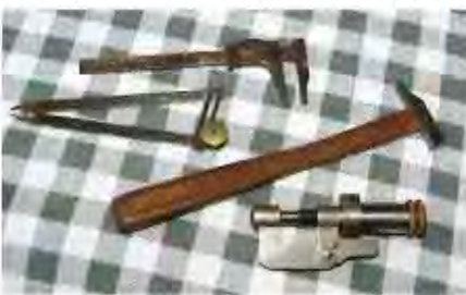
foto 11. Uurwerkmakergereedschap nagelaten door C.J. van Boom. We zien een hamer, een passer, een schuifmaat en een micrometer.
