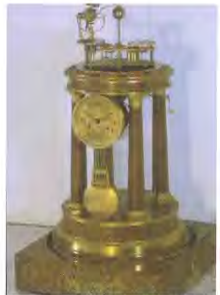
Figuur 9 – Klok met planetarium van Raingo Parijs. 1830. Het planetarium gaat een maal per jaar rond. Er is ook een jaarkalender ingebouwd. Met een zwengeltje kan men het planetarium sneller laten lopen, voor demonstratiedoeleinden. In de voet is een speelwerkje ingebouwd dat muziek uit Der Freischuetz van Karl Maria von Weber laat horen. (Belmont House)
