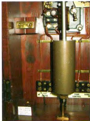
Afbeelding 6: Slinger met transport klem.
