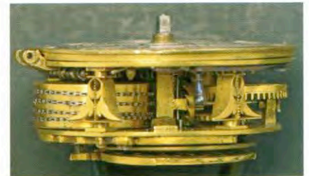
Afbeelding 13: Zijaanzicht van het uurwerk van het horloge uit afbeelding 12.
