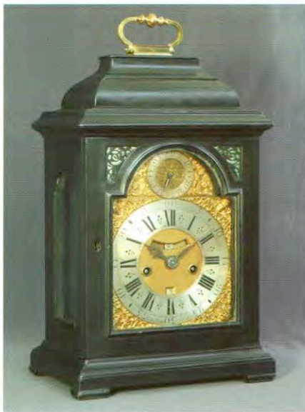
Afbeelding 5: Een later werk van Gretton, met aparte wijzer voor verstelling van de slinger.
