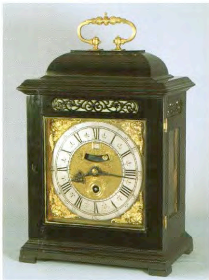
Afbeelding 3: Tafelklok met alleen gaand werk zonder repetitie.
