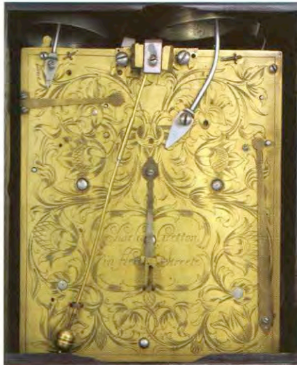
Afbeelding 4: Uurwerk van een tafelklok met kwartierslagwerk.
