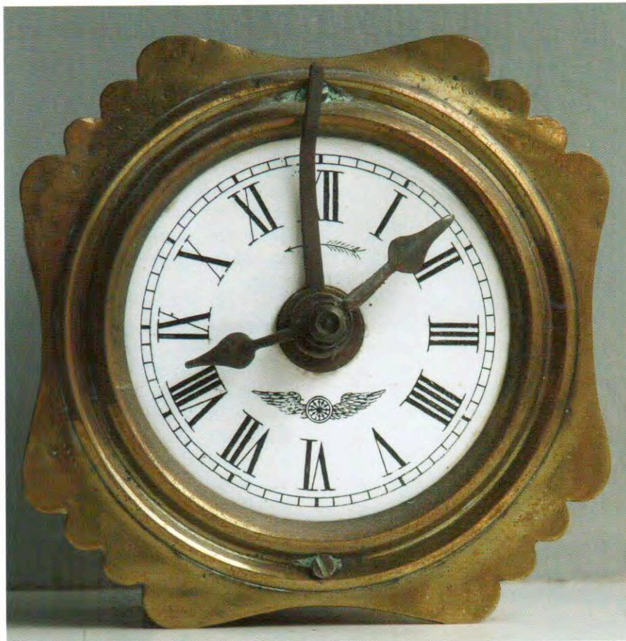
afb. 6 Reiswekker, wekkerinstelling via forse, buiten de wijzerplaat uitstekende, wijzer.
